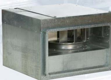
Прямоугольные каналные вентиляторы в шумоизолированном корпусе из оцинкованной листовой стали с звукоизоляцией из стекловолокна толщиной 50 мм. Электродвигатель и рабочее колесо с загнутыми назад лопатками установлены на откидной крышке, что упрощает доступ к ним для чистки и обслуживания. Внешняя клеммная коробка. Температура перемещаемого воздуха от -40°C до +60°C
