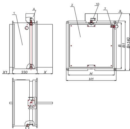
ВЫЛЕТ ЗАСЛОНКИ ЗА КОРПУС КЛАПАНА КПС-1 ПРЯМОУГОЛЬНОГО СЕЧЕНИЯ
