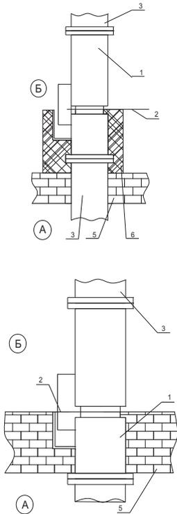
Установка клапана осуществляется в соответствии с требованиями нормативных документов. Клапан монтируется в проеме строительной конструкции с расположением привода, как правило, в помещении, смежном с обслуживаемым (пожароопасным) помещением.
