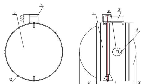
С электромагнитным приводом
