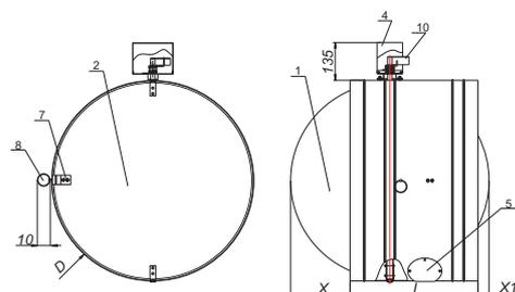
ВЫЛЕТ ЗАСЛОНКИ ЗА КОРПУС КЛАПАНА КПС-1 КРУГЛОГО СЕЧЕНИЯ
